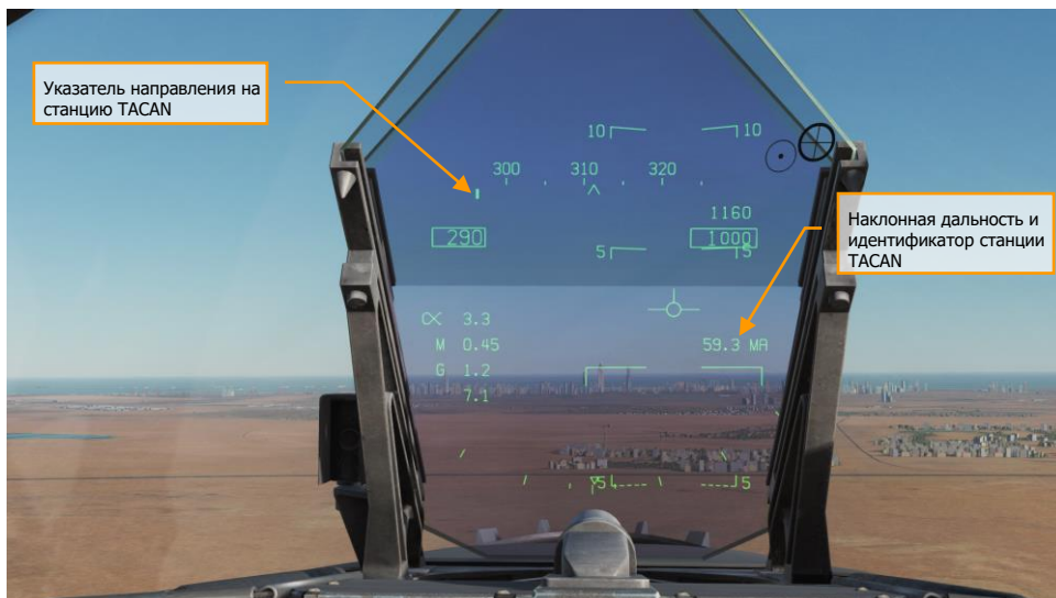
Рисунок 43. Навигационные данные режима TACAN на ИЛС
