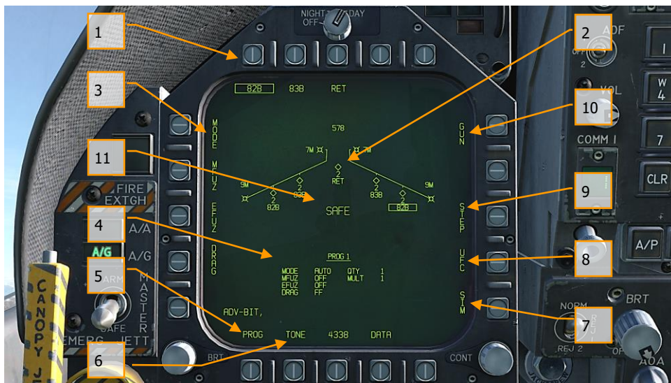
Рисунок 51. Данные неуправляемого вооружения на странице STORES в режиме A/G
