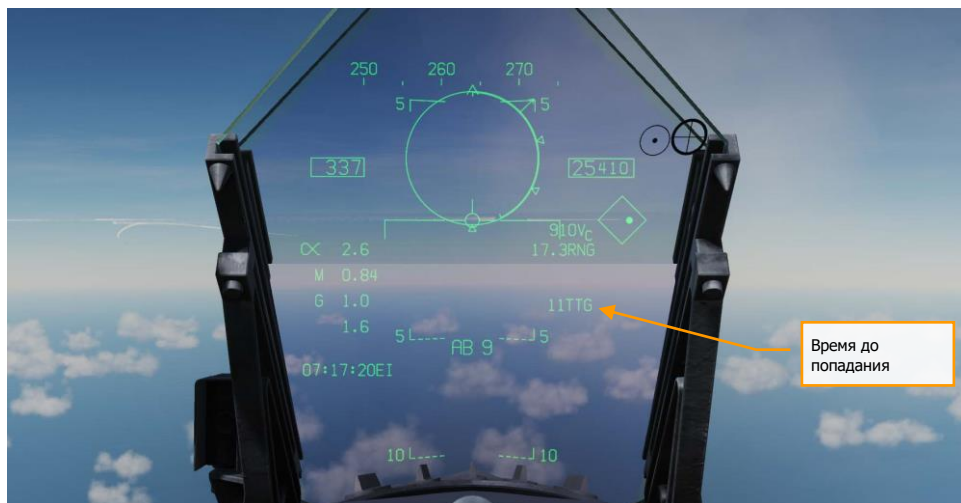
Рисунок 89. Индикация ИЛС после пуска AIM-120 по захваченной цели
