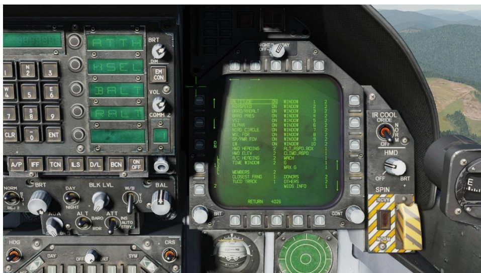
Рисунок 93. Подраздел установок отключения символики нашлемного дисплея
