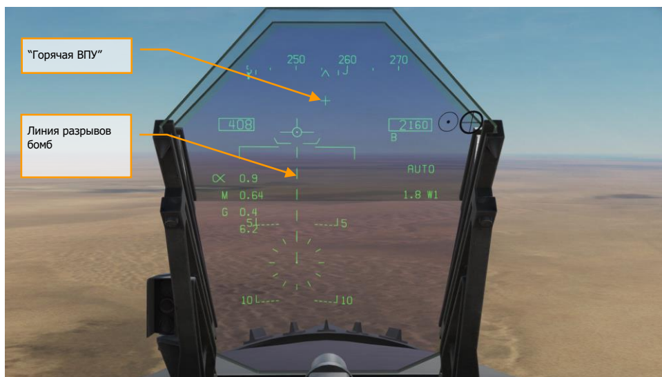
Рисунок 55. Индикация режима AUTO на ИЛС без ЦУ, угол пикирования <7.5
