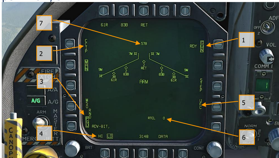
Рисунок 58. Индикация страницы STORES при стрельбе с ВПУ в режиме A/G
