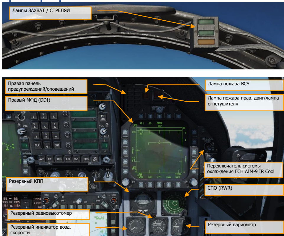
Рисунок 12. Правая приборная панель
