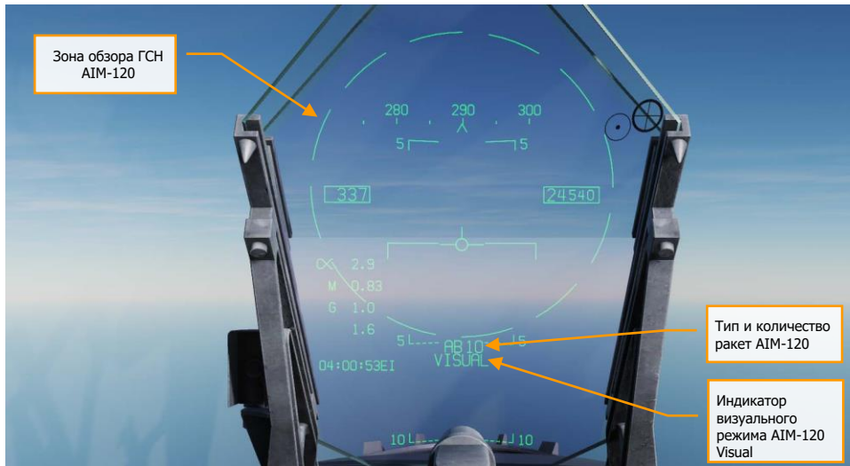
Рисунок 85. Индикация для AIM-120 на ИЛС без целеуказания
