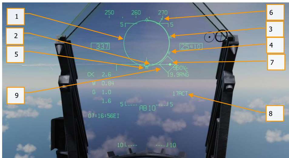
Рисунок 87. Индикация ИЛС до пуска AIM-120 и наличии захвата цели
