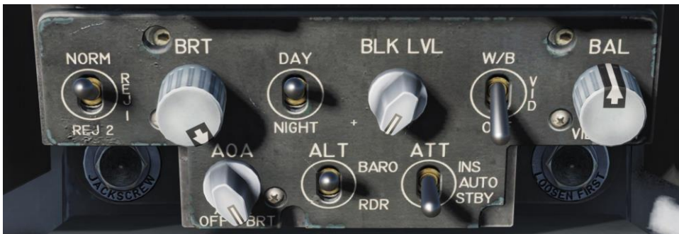
Рисунок 11. Панель управления ИЛС
