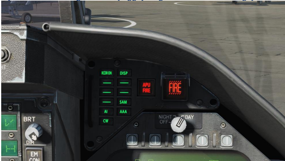
Рисунок 101. Правая панель предупреждений/оповещений (Транспаранты типов угроз)
