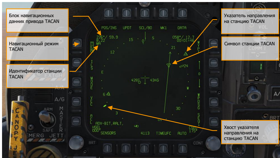
Рисунок 42. Навигационный режим TACAN на HSI
