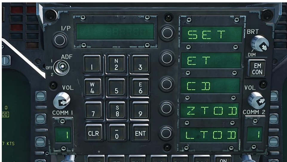
Рисунок 37. Опции TIMEUFC на пульте UFC
