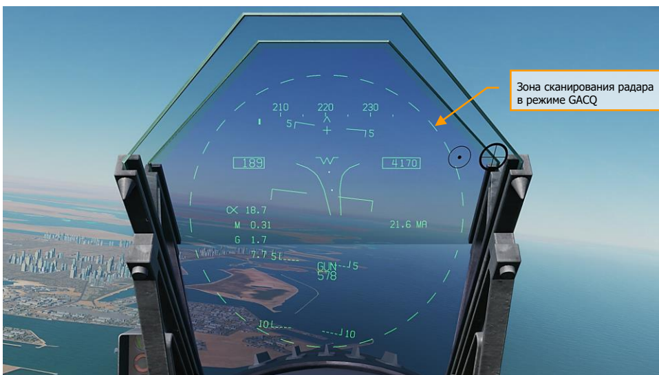
Рисунок 70. Зона сканирования радара в режиме GACQ
