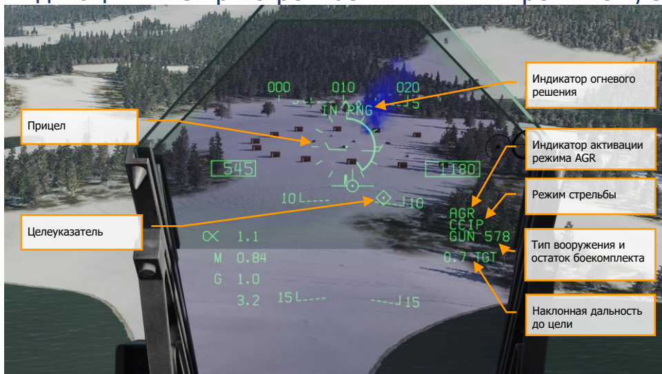
Рисунок 60. Индикация ИЛС при стрельбе с ВПУ в режиме А/Г
